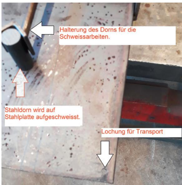
Grundplatte mit Schablone und Stahldorn vor der Bearbeitung mit der Schweissanlage
